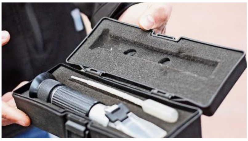
Ein kleiner Kasten mit besonderem Inhalt: ein Refraktometer. Der Name dieses Messgerätes war der erste Fachbegriff, den der junge Mann zu Beginn seiner Ausbildung lernte.
